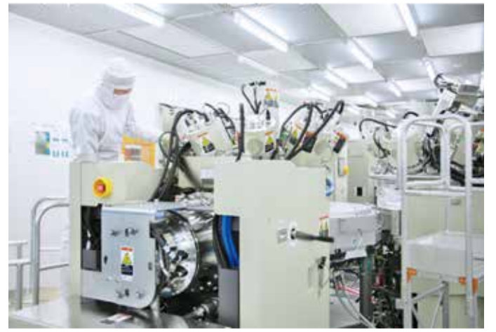
真空中で薄膜を形成・加工するための超真空スパッタリング装置(提供:東北大学)
