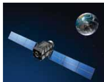
準天頂衛星初号機「みちびき」三菱電機が衛星バスシステムの設計・製造を担当した準天頂衛星「みちびき」。複数の衛星を準天頂軌道(日本のほぼ真上を通過する軌道)に配置しているため、GPS衛星と併用することで、山間部や都心の高層ビル街などこれまで測位が難しかった場所での測位精度を向上させることを目指し、2010年9月11日にH-IIAロケット18号機によって打ち上げられた。詳しくはJAXAの「みちびき」特設サイト(http://www.jaxa.jp/countdown/f18/index.html) 出典 (C) JAXA
